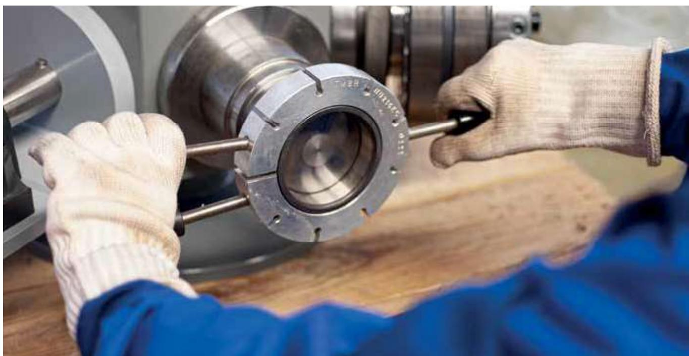
SKF TMBR serisi alüminyum ısitma halkaları belli bir rulman bileziğine tam olarak uyacak şekilde imal edilir. Sipariş detaylarının bulunduğu listeler, belli bir rulman kodu için doğru TMBR'yi bulmayı kolaylaştırır.
