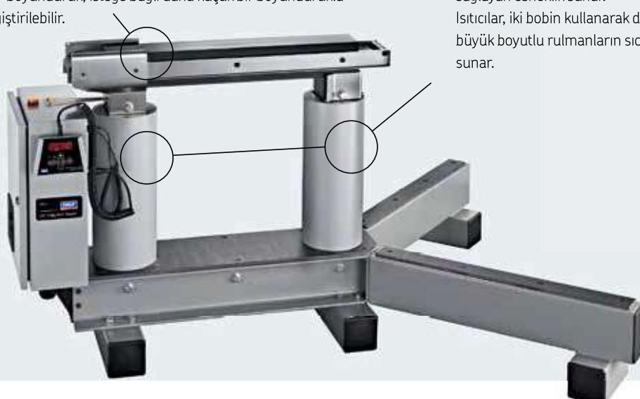
Çift bobinli tasarım, rulmanları yatay veya düşey doğrultuda ısıtmak için sağladığı yüksek performansın yanı sıra hızlı ve rahat montaj için yatağı mille aynı doğrultuda ısıtmayı sağlayan esneklik sunar. Isıtıcılar, iki bobin kullanarak daha homojen ısıtma sağlar ve büyük boyutlu rulmanların sıcak montajı için ek güvenlik sunar.
