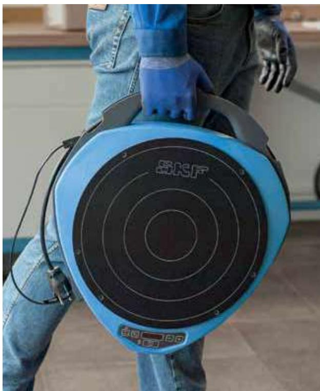
Elektrik enerjisiyle çalışan TWIM 15, rulmanın iç ve dış bilezikleri arasındaki sıcaklık farkının düşük kalmasını sağlayan yüksek sıcaklığı dayanıklı cam elyaf takviyeli plastik yapıya sahiptir. Böylece iç bileziğin dış bileziğe göre çok fazla ısıl genleşmeye maruz kalmasından kaynaklanan iç gerilmeleri azaltmaya yardımcı olur.
