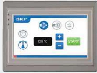
Montaj veya demontaj için seçilen sıcaklığı ulaşıldığında ısıtıcıyı durdurmak için otomatik sıcaklık kontrolüyle kolay kullanım.
