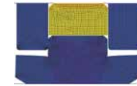
Basınç: 0 bar akma boşluğu «S»: 0.5 mm
