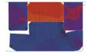
Basınç: 250 bar akma boşluğu «S»: 0.5 mm
